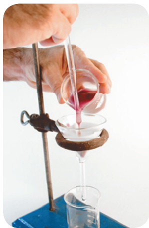
Fig. 3.6. No muevan el papel filtro mientras está en el embudo, para que no se rompa y pierdan parte del sólido.
