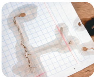
Fig. 3.1. El ácido sulfúrico es la sustancia que se produce en mayor cantidad en la industria química, reacciona con la materia orgánica y la oxida. Al papel y a la madera que aparecen aquí, les escurrió una gotita de este material.
