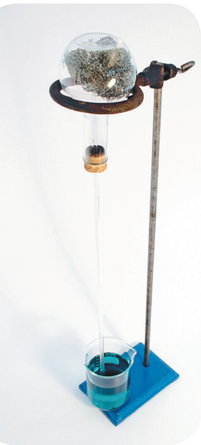
Fig. 3.3. Asegúrense de que el tapón quede bien colocado para que el sistema no tenga fugas. Si no cuentan con matraz, pueden cambiarlo por una botella de plástico rígido.
